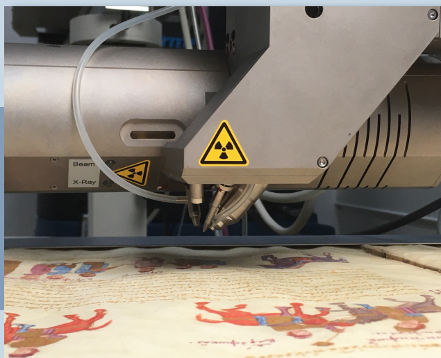
Estudio mediante Fluorescencia de rayos X. Fotografía IPCE.
